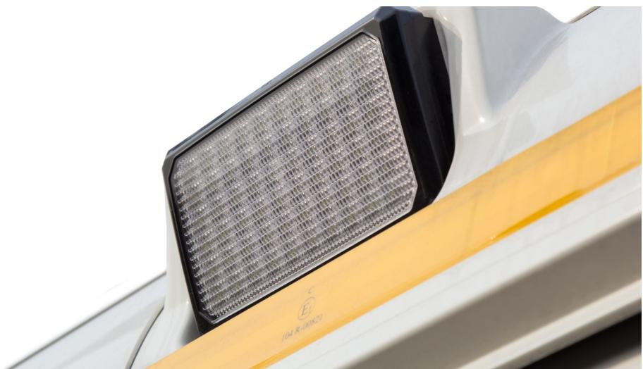
**Осветительные энергосберегающее светодиодные приборы** в верхней части кузова (сзади, слева и справа по бортам) расположены для освещения рабочей зоны вокруг АЦ в темное время суток.
