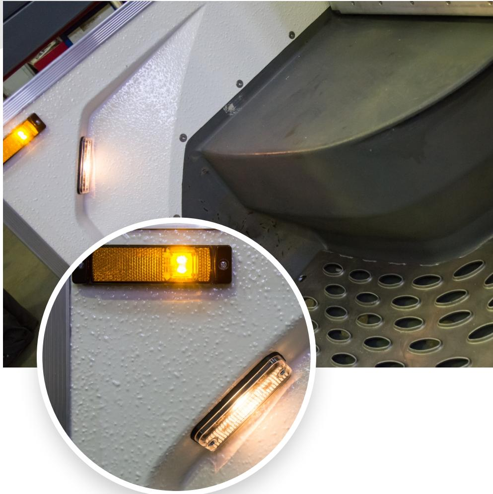
Кабина расчета АЦ оборудована автоматически выдвигающимися и подсвечивающимися ступеньками, при открывании двери.
