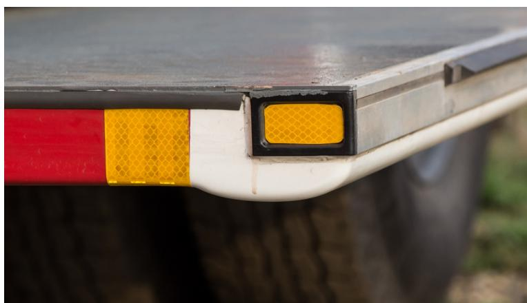
**Стеклопластиковые панели**, из которых выполнена нижняя часть автомобиля, обшивка откидных полок, поворотных ступеней и задние углы стойки к повреждениям, пластичны, легкозаменимы при выходе из строя и обладают низкой стоимостью.
