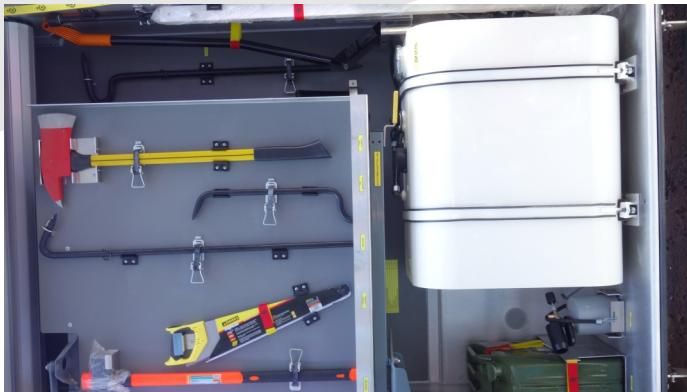
Топливный бак объёмом 260 литров установлен в закрытом, герметичном отсеке (400 км пробега + 7 часов работы).
