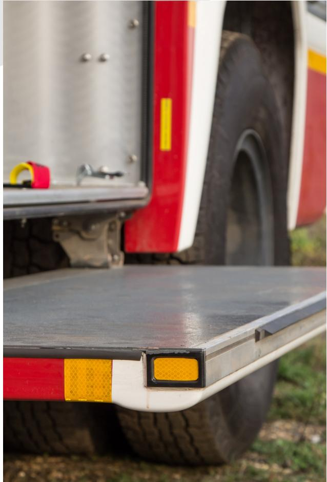
Двери отсеков под ПТВ в нижней части кузова АЦ откидываются и выполнены в виде подножки для доступа к ПТВ, расположенного в верхних отсеках.
