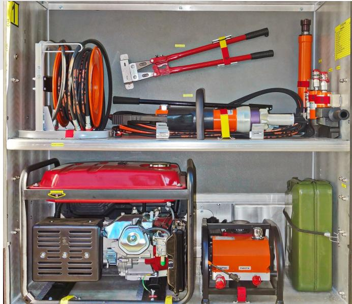
**Конструкция механизмов крепления полок для ПТВ,** находящегося в 1, 2, 3 и 4 отсеках предусматривает установку направляющих профилей, с целью изменения расстояний между полками в зависимости от габаритов перевозимого оборудования.
