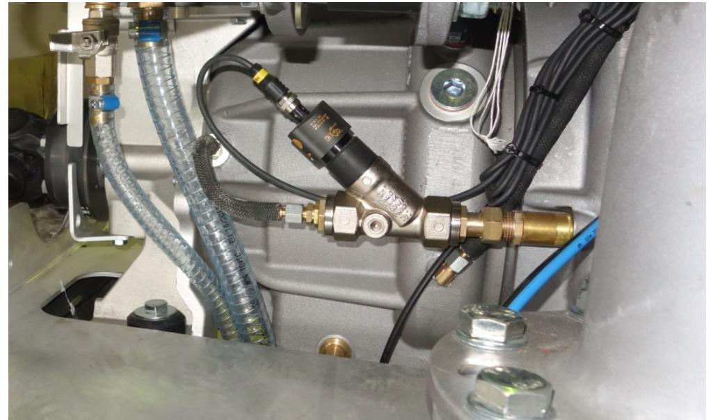
Для предотвращения работы насоса всухую на экране информационного дисплея имеется контроль потока воды, направляемого на охлаждение подшипников скольжения стального вала пожарного насоса.
