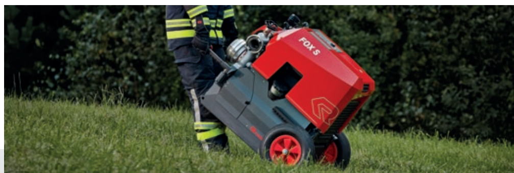
Благодаря колесам обеспечивается транспортировка мотопомпы усилиями всего одного человека
