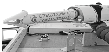
⑤ Лафетный ствол RM25E с электронным управлением из кабины водителя. Дальность подачи воды до 70 м, производительность 50 л/с. Возможность работы в движении
