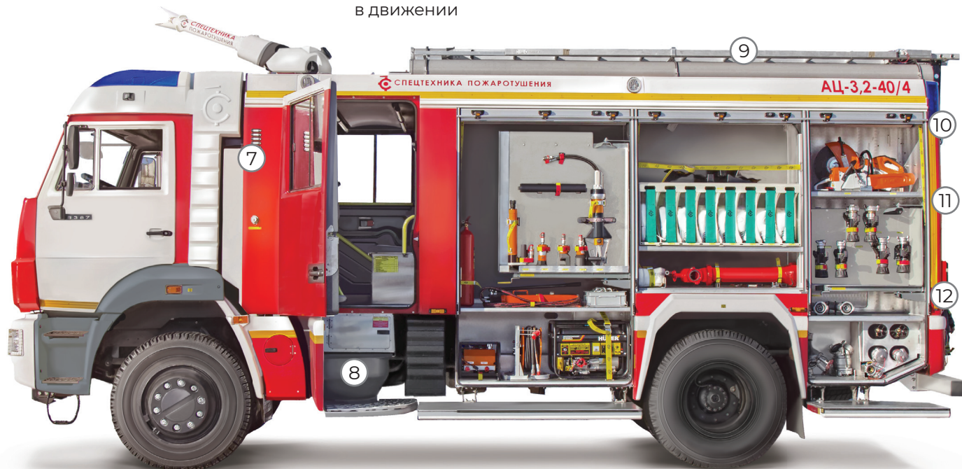
④ Телескопическая мачта с LED-прожекторами напряжением 24 В и суммарной потребляемой мощностью не более 200 Вт. Подъем на высоту до 5 метров от земли
