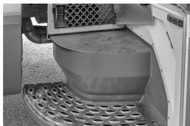
⑧ Дверь с интегрированной автоматически выдвигающейся ступенькой, подсвечивающейся при открывании двери
