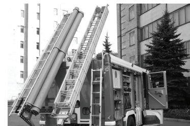
⑨ Ручные лестницы с системой «комфорт» для быстрого подъема, снятия лестниц с земли
